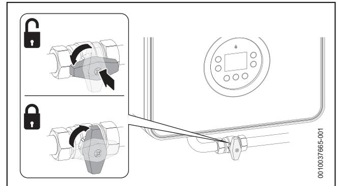
Fig. 4 Abertura/fecho da válvula de gás
